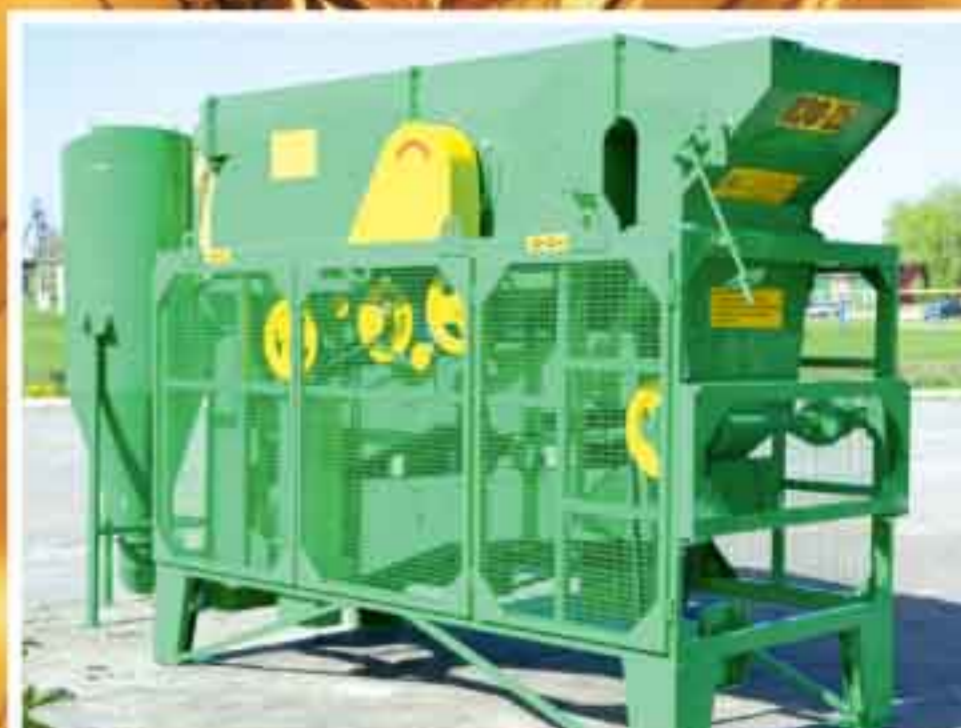
Очиститель зерна фракционный «ОЗФ-25»
