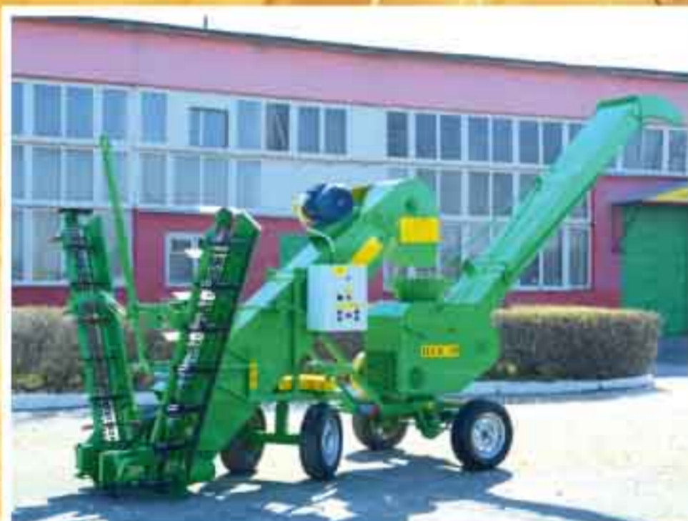
Погрузчик зерна электрический самоходный «ПЗЭС-200»
