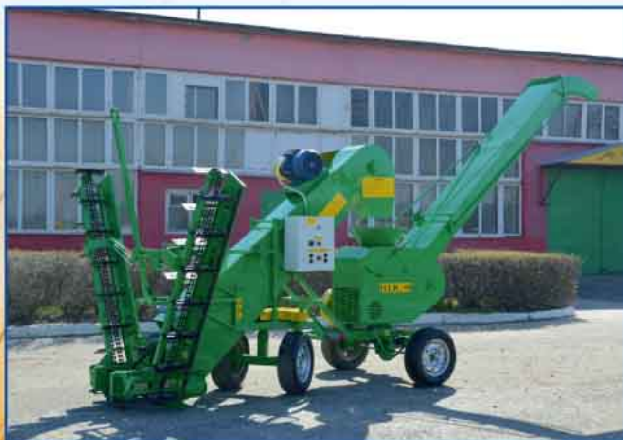
Погрузчик зерна электрический самопередвижной «ПЗЭС-90»
