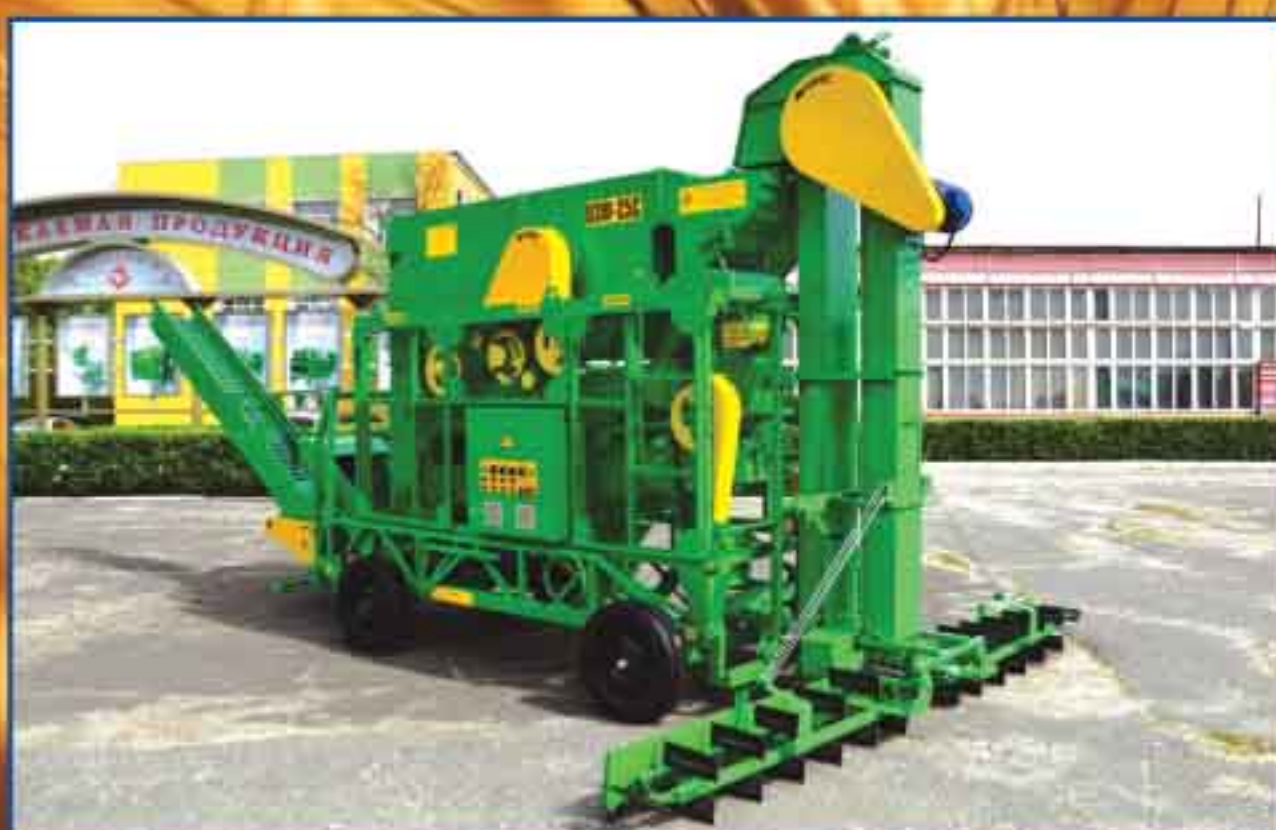
Очиститель зерна фракционный «ОЗФ-25С» (самопередвижной)
