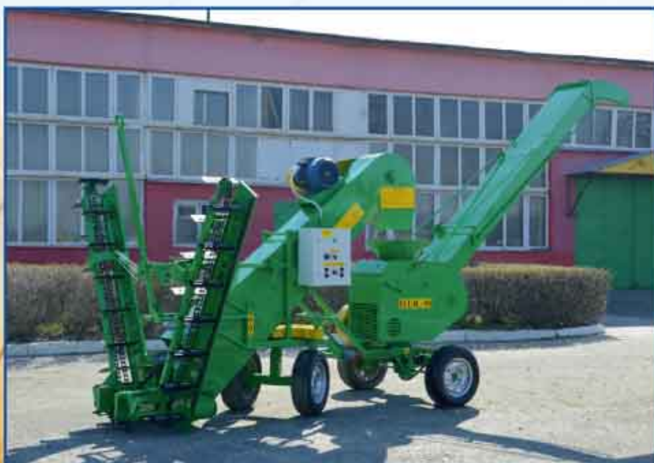
Погрузчик зерна электрический самопередвижной «ПЗЭС-90»
