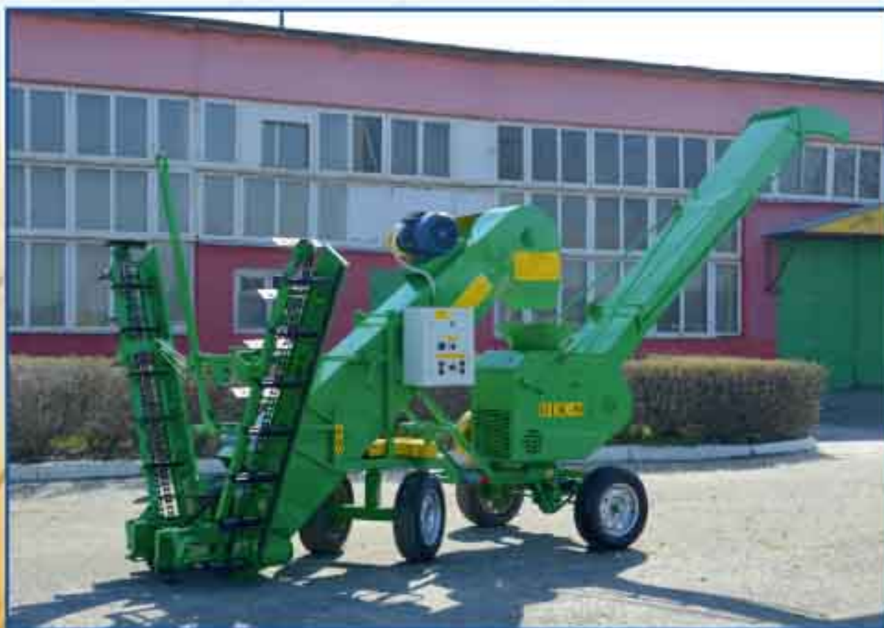
Погрузчик зерна электрический самопередвижной «ПЗЭС-90»
