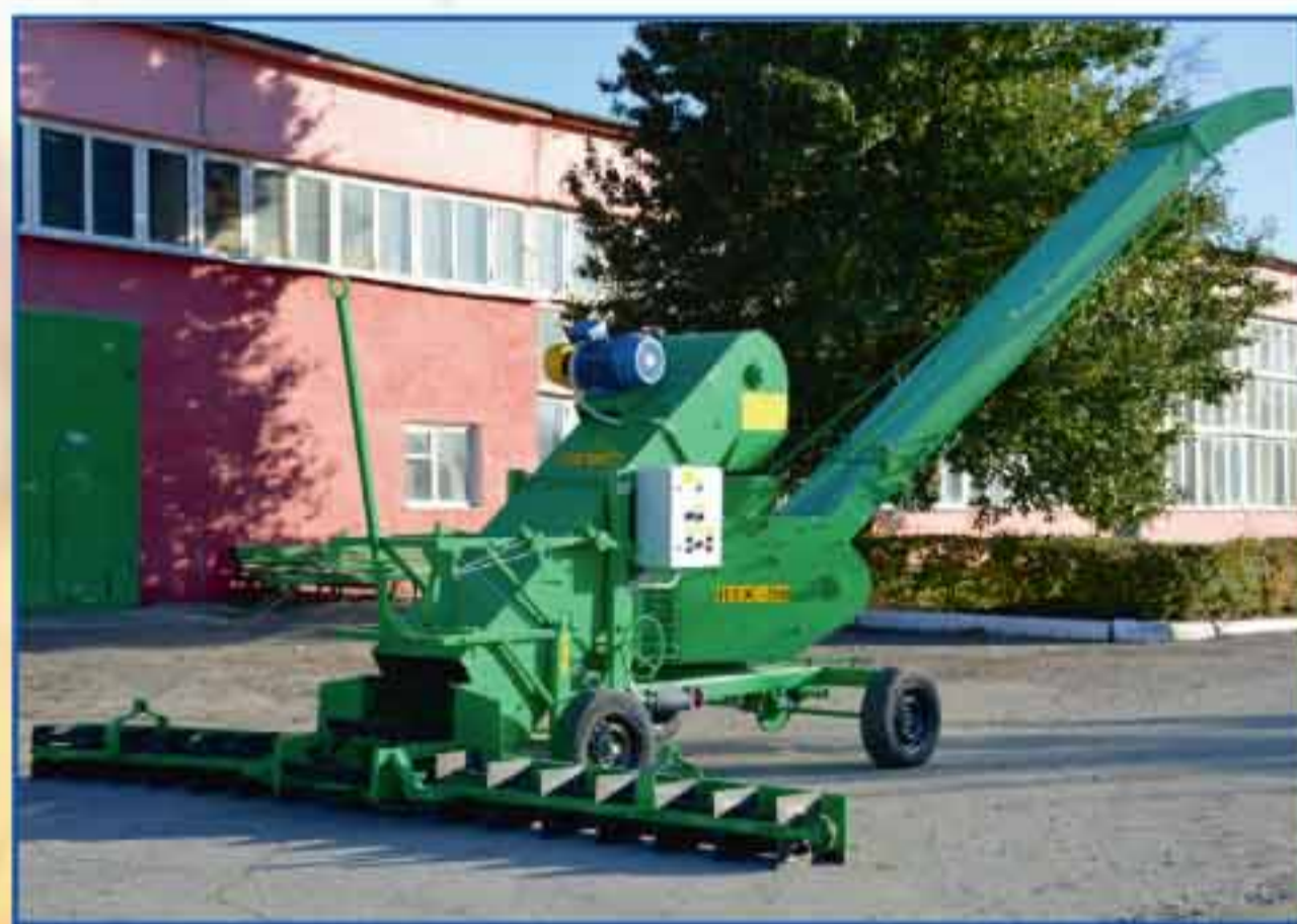
Погрузчик зерна электрический самоходный «ПЗЭС-200»
