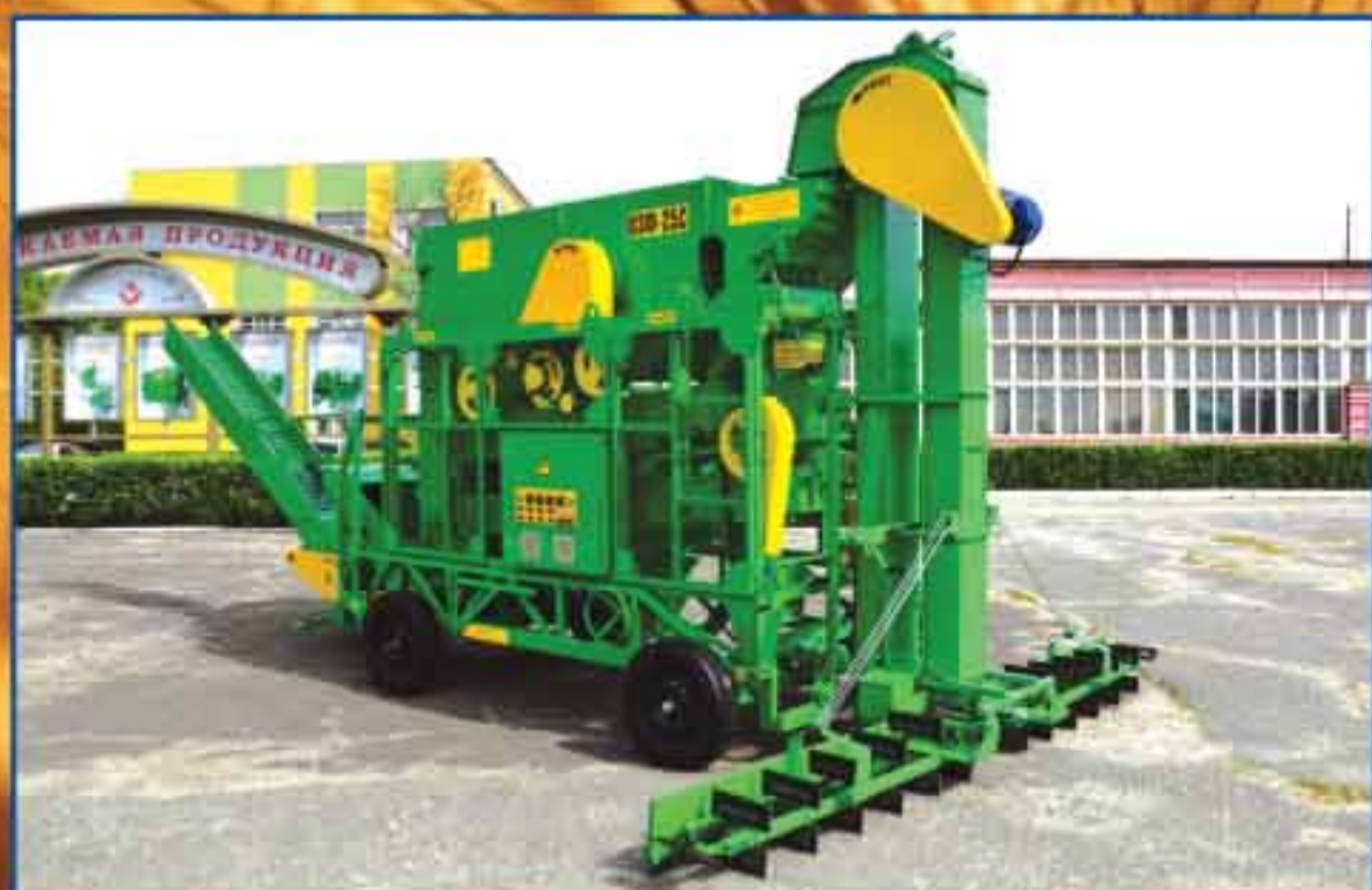
Очиститель зерна фракционный «ОЗФ-25С» (самопередвижной)
