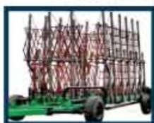
**Почвообрабатывающие агрегаты с шириной захвата от 10 до 27 м** для навешивания зубовых борон в один ряд и с шириной захвата от 9 до 28 м для навешивания зубовых борон в два ряда в шахматном расположении.
