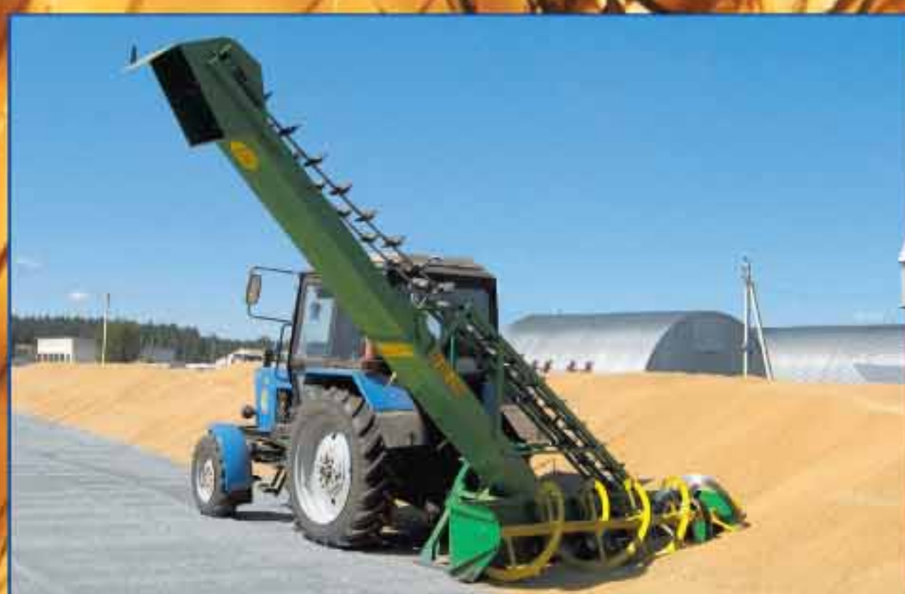
Погрузчик зерна навесной «ПЗН-250»
