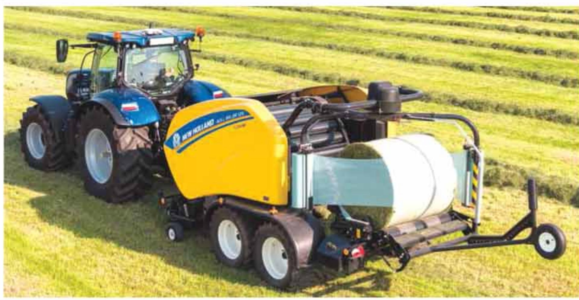
Модели рулонных пресс-подборщиков компании «Навигатор – Новое машиностроение» в серии NB, выпущенной на рынок 2018 году, оснащены роторным измельчителем с семнадцатью ножами.
