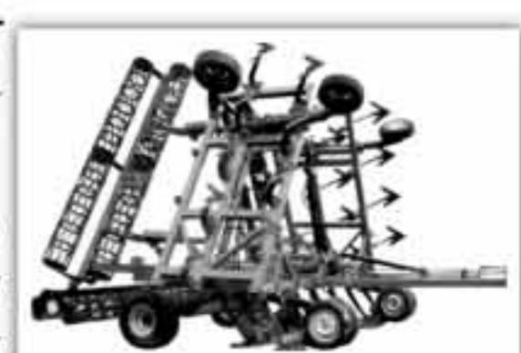
Подпружиненные стойки культиваторов КСО за счет вибрации во время работы меньше забиваются почвой, растительными остатками и снижают энергетические затраты. Производятся агрегаты с шириной захвата от 5.6, до 14 м.
