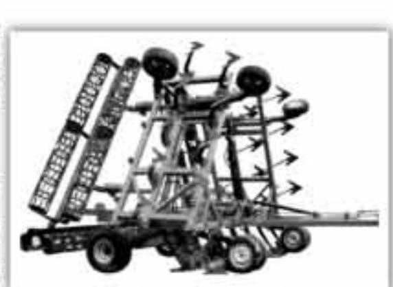
Подпружиненные стойки культиваторов КСО за счет вибрации во время работы меньше забиваются почвой, растительными остатками и снижают энергетические затраты. Производятся агрегаты с шириной захвата от 5,6, до 14 м.
