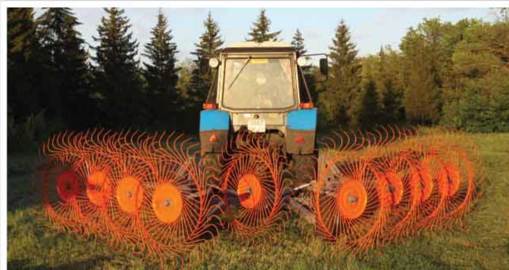
Грабли колесно-пальцевые H90V8C – универсальная и надежная модель.
