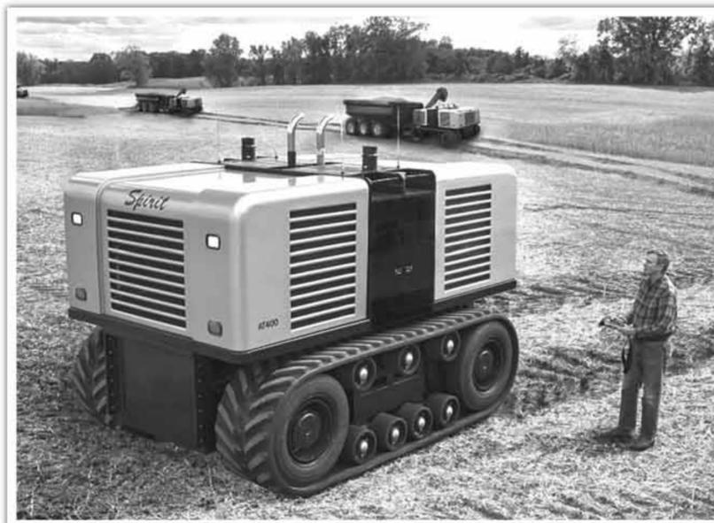
особенность трактора - привод eDrive. Электропитание данной комбинации электромоторов обеспечивает бортовой генератор на базе двигателя внутреннего сгорания. Мощность привода может составлять 74, 147 и 294 кВт. Обе обозначенные системы могут устанавливаться и на другие шасси.
