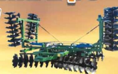
**Культиватор плоскорез широкозахватный КПШ - 9, 11, 13**
