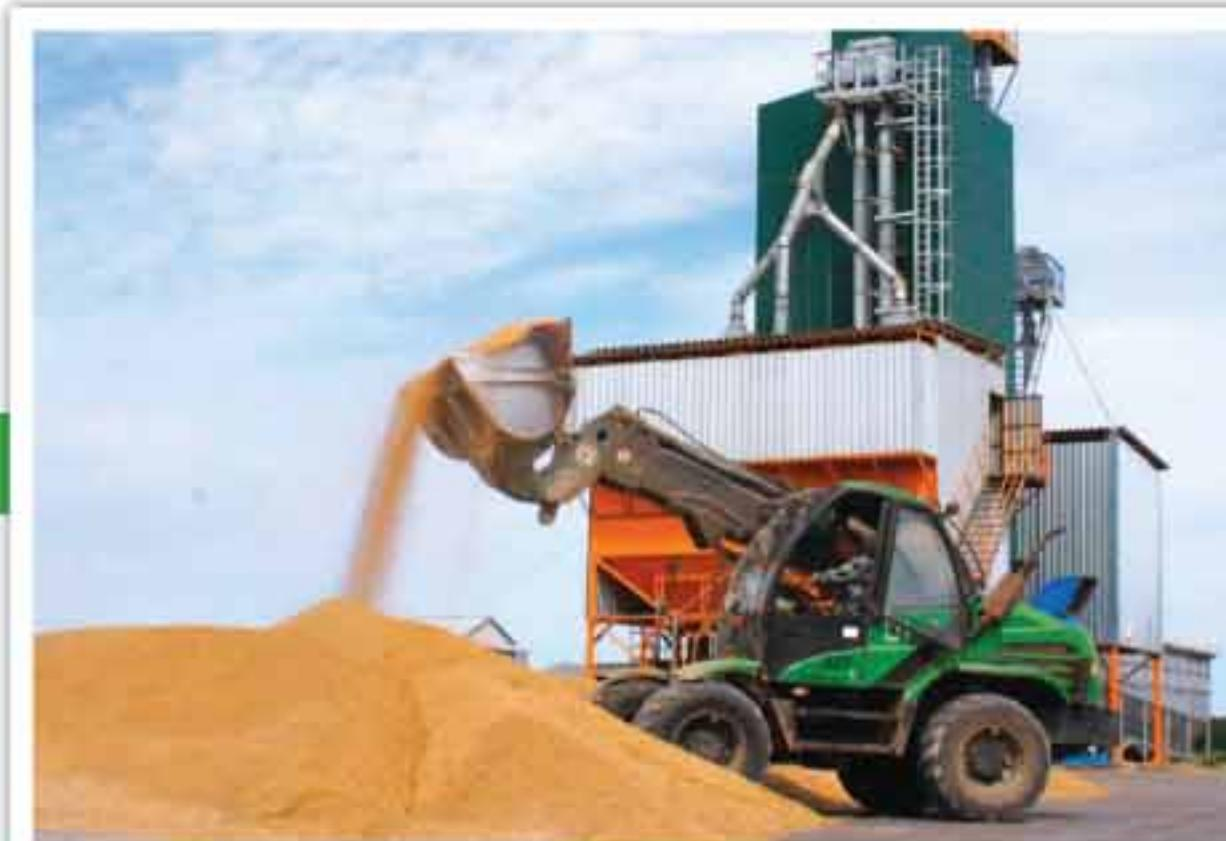
расположенную перед оператором погрузчика. При приближении небезопасных значений нагрузки подаются соответствующие сигналы, после чего система ограничивает диапазон работы стрелы, и отключает функции её подъема и вытягивания. После укорачивания стрелы до уровня приемлемой нагрузки её функциональность восстанавливается в автоматическом режиме.
