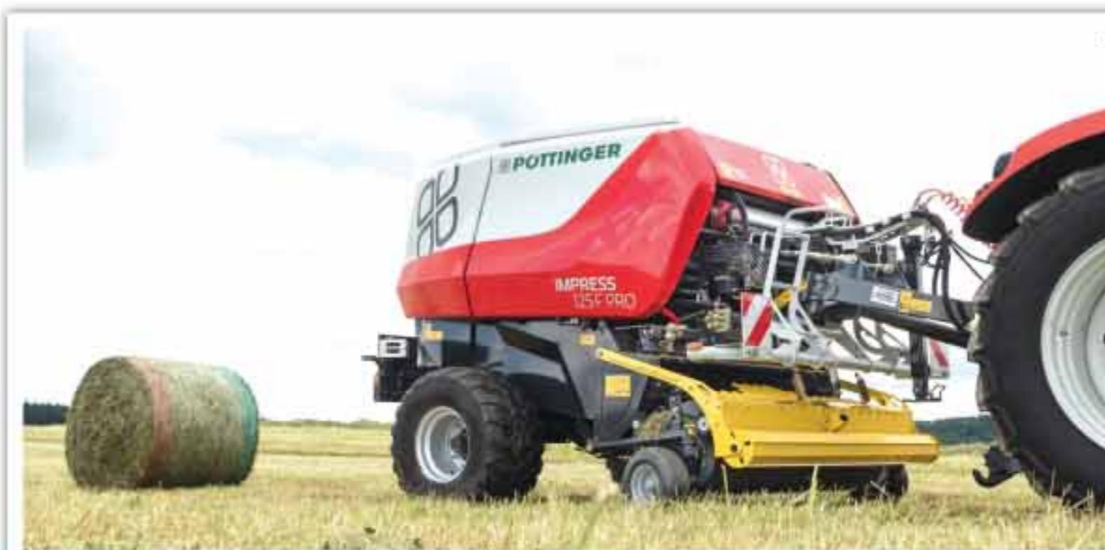
— Задача преобразований — создание большего давления на массу, — поясняет он. — Два поршня, приводимые в движение совместно, воздействуют со 100%-ной силой прессования на 50% площади тюка каждый, что позволяет удвоить степень уплотнения на квадратный сантиметр массы. Удар производится сначала в нижнюю часть тюка, потом в верхнюю. Это дает возможность на 25% увеличить плотность по сравнению с предыдущими моделями LSB.
