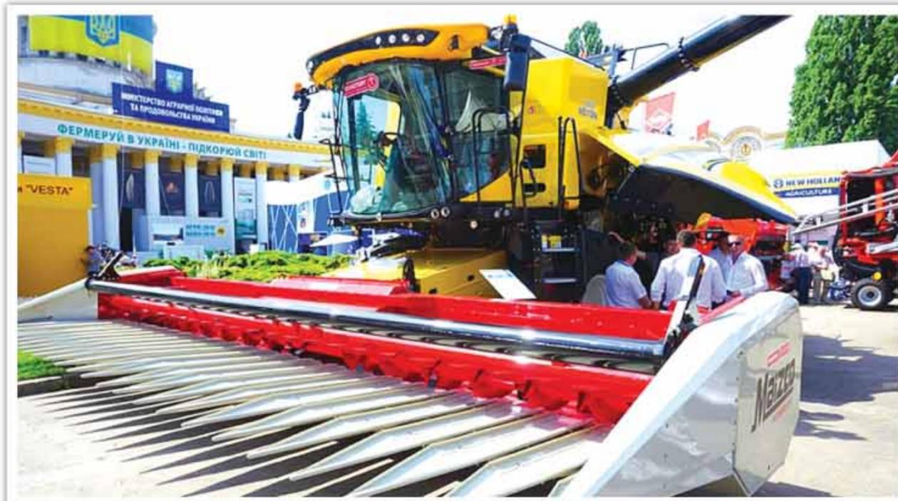
ется двигателем 8,7-литровым FPT Cursor номинальной мощностью 389 л.с. (максимальная – 422 л.с.). В паре с ним – 4-ступенчатая гидростатическая трансмиссия.
