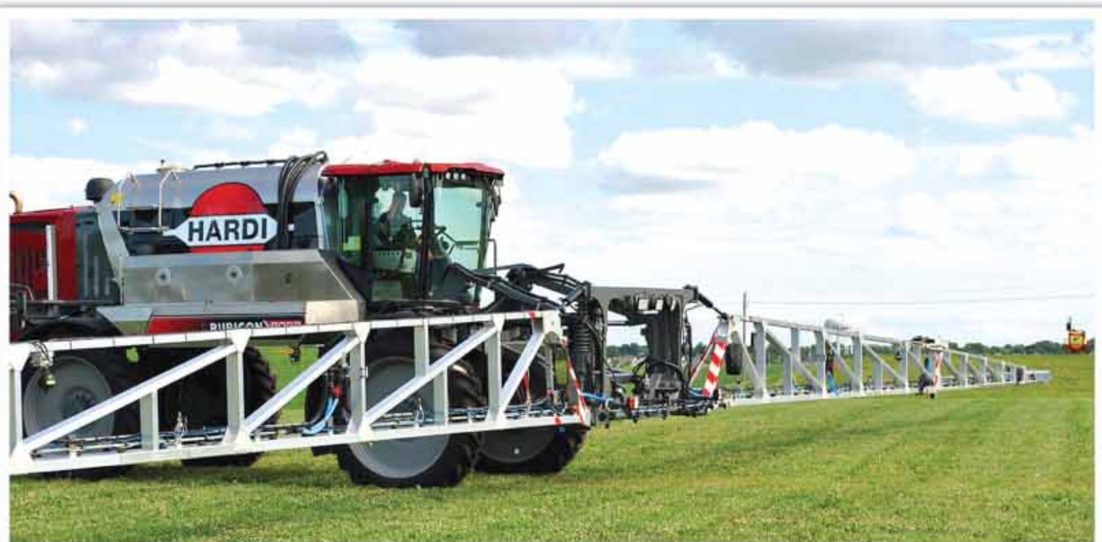
реализована система нового поколения Autoboam XRT. А в последних «Пантерах» от Amazone систему DistanceControl сменила система ContrControl. Новое поколение датчиков более компактно, они устанавливаются внутрь рамы, что снижает риск их повреждения. Кстати, штанга при этом также претерпела ряд изменений, которые позволили увеличить ее прочность.
