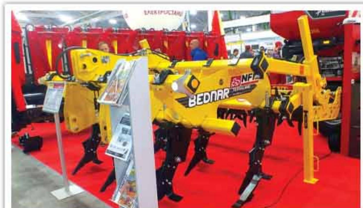
1500 TN с поддержкой дифференцированных норм. Напомним, Bednar Terraland TN используют для основной обработки почвы на глубину 25–55 см, а так же для разрушения плужной подошвы и оздоровления почвенного профиля. По сравнению с классическими плугами, агрегат Terraland TN, благодаря своей конструкции долот, позволяет производить обработку всех видов почв при использовании тракторов меньшей мощности.
