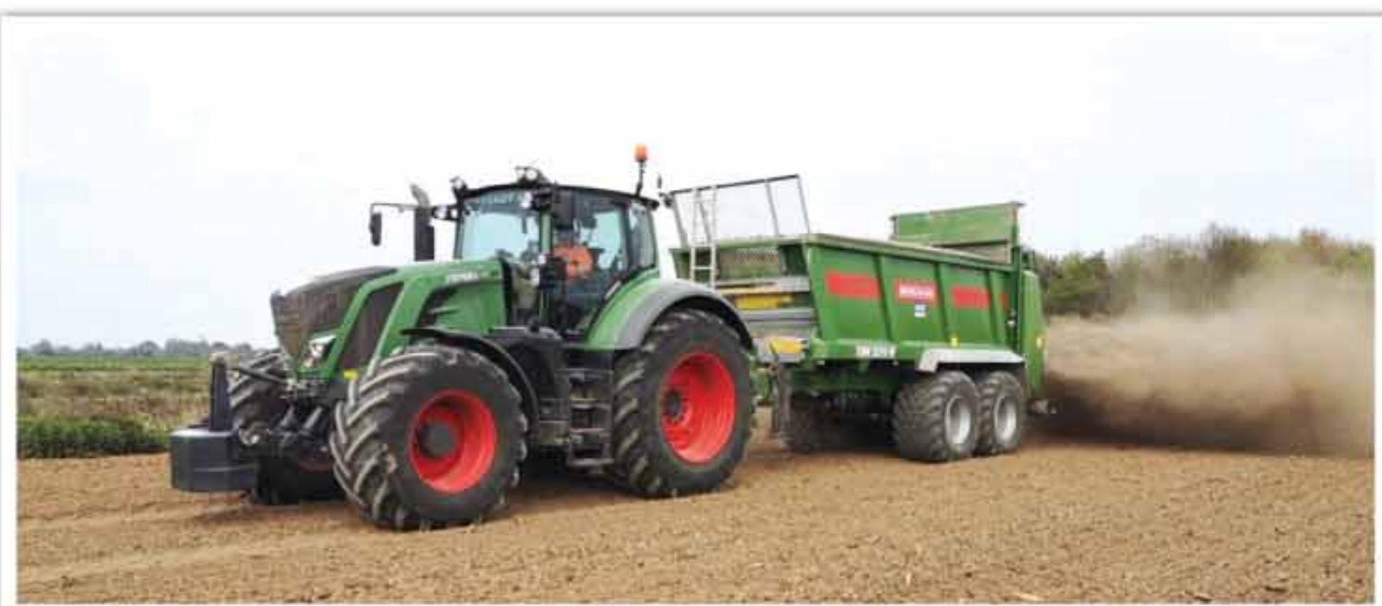
– Система модернизировалась, и на Axis нового поколения уже устанавливается более точная версия EMC, – добавляет Александр Щербик. – Замер происходит непосредственно с вала, на котором устанавливается диск, что позволяет избежать погрешностей в редукторах.
