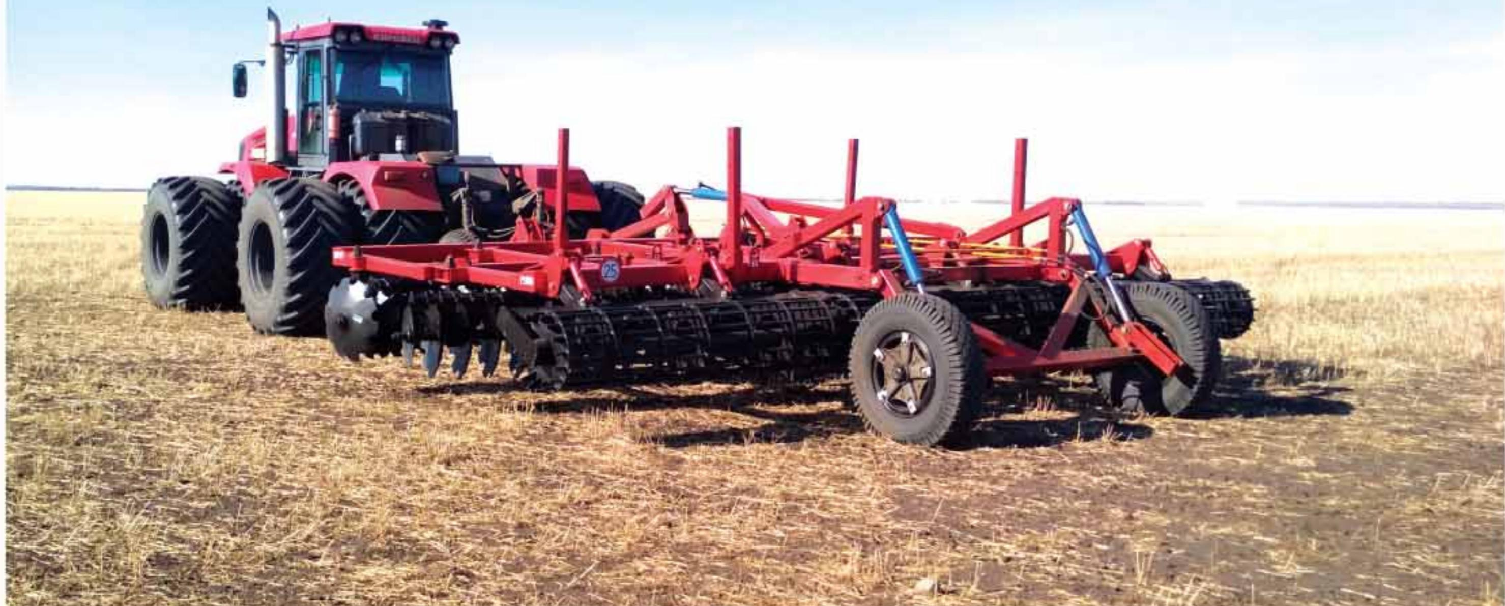
**Рисунок 2 б. Дисковая борона ТДБ-7,0 в агрегате с трактором Buhler 2375 Versatile**
