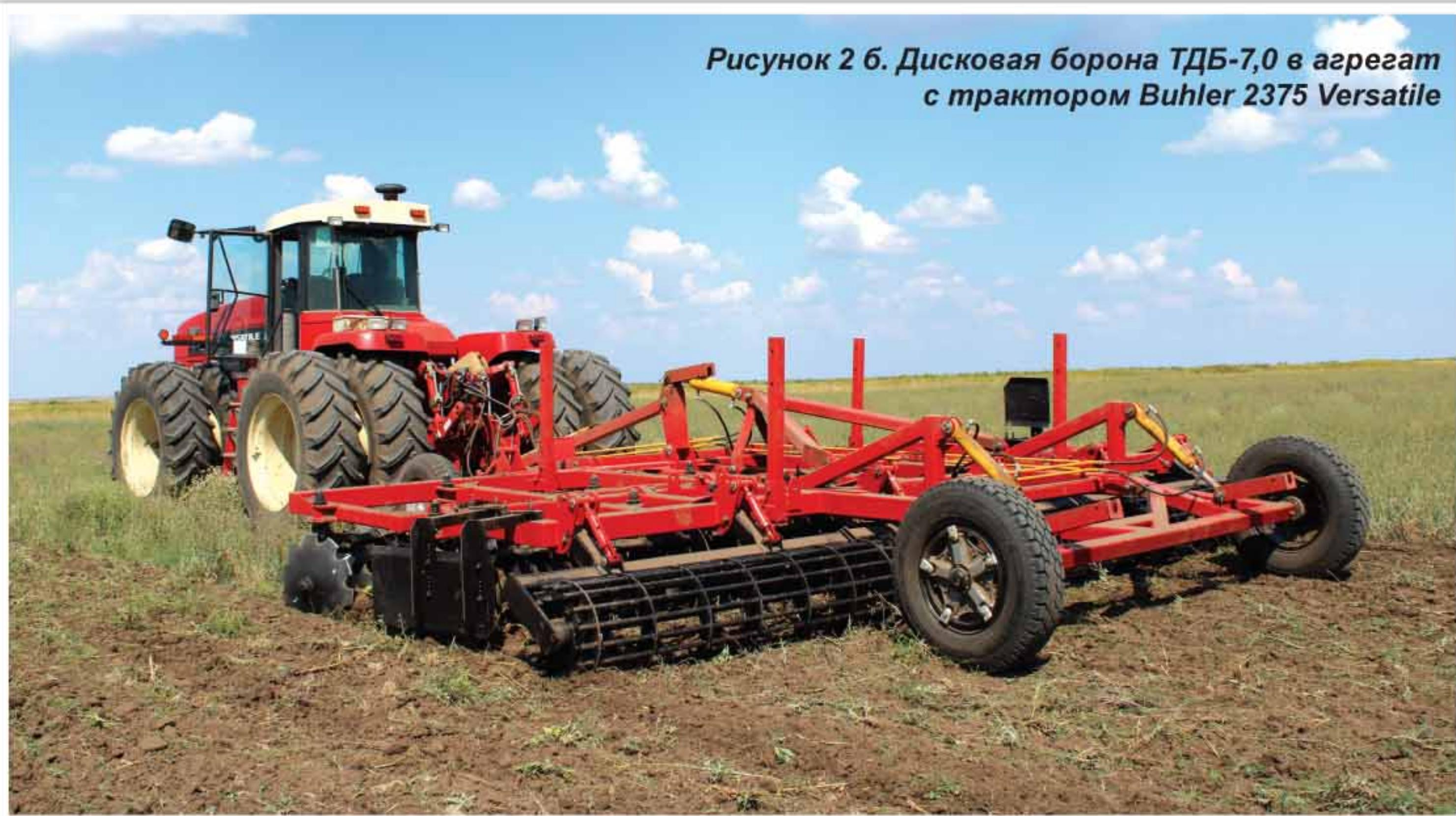
дисковые, катки прутковые прикатывающие, стойки для хранения орудия и гидросистема, предназначенная для перевода бороны из транспортного положения в рабочее и обратано. Прикатывающий прутковый каток дополнительно крошит, одновременно уплотняет и выравнивает обработанную поверхность поля.
